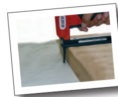
Grâce à son bec de 50 mm de long, cette agrafeuse va dans les endroits difficilement accessibles.
