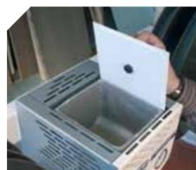
Bac à colle d'accès facile. Système d'application de colle doté d'un rouleau en silicone antiadhérant pour un nettoyage simple et rapide.
