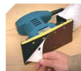
Fixation des abrasifs velcro (avec 8499219)
