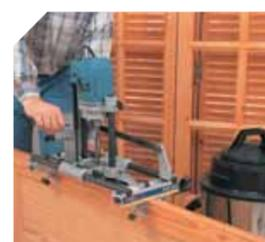
Possibilité de travailler en position horizontale. Pour réaliser des mortaises en série, sur des portes démontées (aspiration indispensable).
