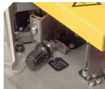
Système de réglage de l'épaisseur du chant très simple et rapide. Permet l'utilisation de chants jusqu'à 3 mm d'épaisseur.
