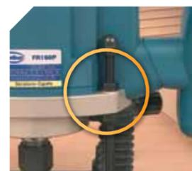
Blocage de la profondeur de défonçage.
