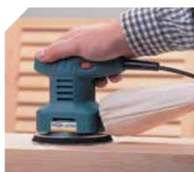
En rotatoriale, combine deux mouvements: rotatif et vibrant.
