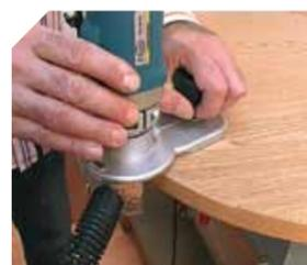
La tête CA56U permet l'affilage de façon ininterrompue des quatre chants d'un panneau. Parfaite stabilité grâce à sa grande table. C'est l'outil idéal pour la réalisation de travaux d'arasage, sur le bord ou au centre du panneau.
