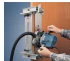
Usinage des orifices latéraux pour la pose de la poignée, du barillet et autres mécanismes.
