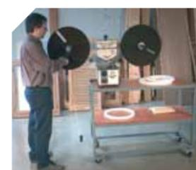
Son emploi et sa mise en marche permettent de préencoller des rouleaux rapidement et simplement.
