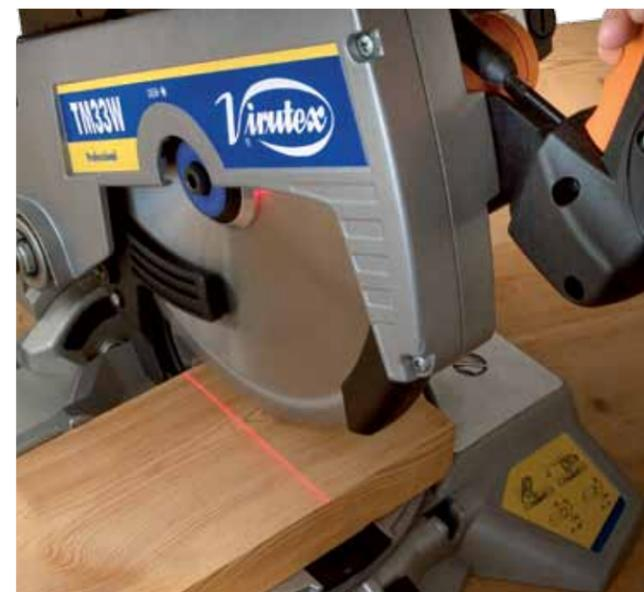
Trait de scie précis à rayon laser, actif dès la mise en route. Boîtier laser de série monté directement sur le moyeu de la lame afin de garder la précision de sciage dans tous angles de coupe. Boîtier laser équipé d'un bouton (marche/arrêt) lors des travaux de délignage.
