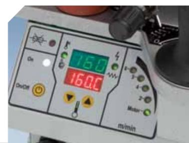
Réglage de la température (120 à 200°C) contrôlée par microprocesseur pour une mesure plus précise. Système de contrôle de la température par impulsions. Protège les résistances de chauffage et augmente sa durée.
