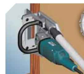
Délimitage du dormant ou châssis de fenêtre avec équerre d'appui réglable.
