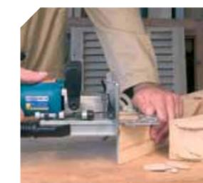
Assemblage robuste avec les lamelles No. 6.
