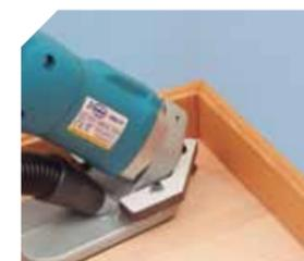
Permet de surfer les angles inaccessibles pour les ponceuses à parquet.
