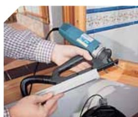
Fournie avec 2 guides interchangeables permettant la réalisation de rainures obliques à 45° ou droites.
