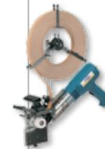
Plaqueuse de chants manuelle pour placage des faces internes, des feuillures de portes et de battants.
