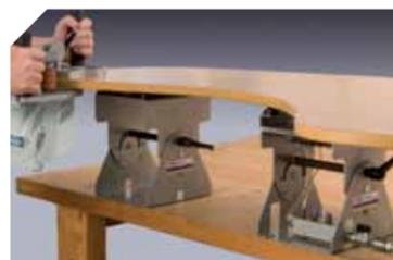
Mise en place d'une table auxiliaire SVN680. L'utilisation de plusieurs tables est pré-conisée pour le serrage et l'usinage en toute sécurité de grandes surfaces.
