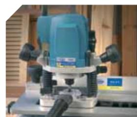
Vis sans fin avec contre écrou pour le blocage de la profondeur de défonçage. Idéal pour le réglage des mèches à queue d'aronde ou autres nécessitant un blocage ferme et précis de la tête.
