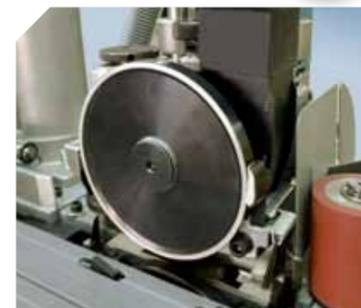
Unité d'affleurage à réglage rapide par compteur numérique. Permet l'affleurage à biseau ou avec différents rayons. Avec racleur double effet pour une finition parfaite sans résidu de colle. Coupe en bout automatique.
