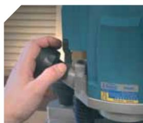
Interrupteur et blocage de la tête accessible de la poignée. Contrôle total de la machine.
