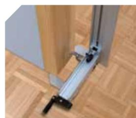
Fixation du rail sur le dormant en quelques minutes. Rail équipé de niveaux pour assurer une parfaite horizontalité et verticalité de la coupe.
