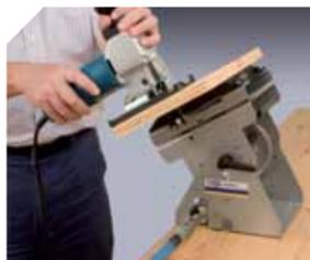
Permet placer la pièce à usiner dans la position la plus convenant.
