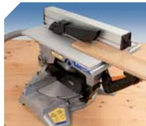
Grande table pour travaux de délignage. Hauteur de coupe de 0 à 55 mm réglages par colonne à crémaillère. Guide à onglet, en option (voir page 76).
