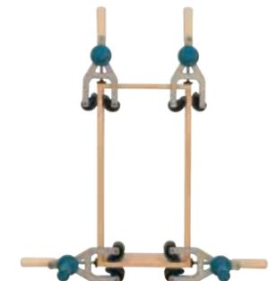
Montage/serrage d'un caisson
