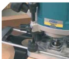
Butée revolver à 6 positions pour une sélection rapide de la profondeur de travail souhaitée.
