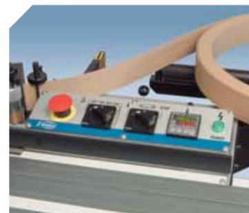
Panneau de contrôle simplifié. Réglage électronique de la température de la colle sans oscillations contrôlée par microprocesseur.
