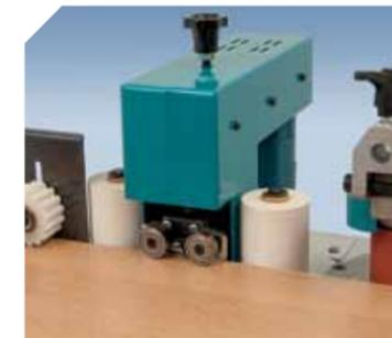
Profilage de l'excédent des bords jusqu'à 1 mm d'épaisseur.
