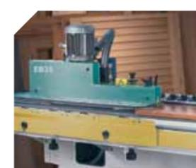
Entraînement par courroie garantissant une parfaite régularité de l'avance du panneau.
