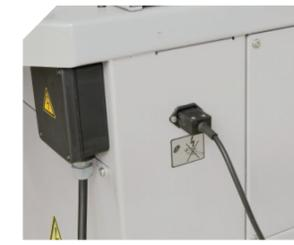
Une aspiration efficace et de qualité est indispensable au fonctionnement de la plaqueuse. Nous recommandons l'utilisation de notre aspirateur AS382L (en option) muni d'une connexion électrique spéciale accouplée à la plaqueuse permettant un démarrage et l'arrêt automatique.
