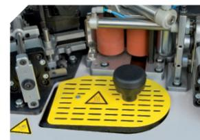
Bac à colle recouvert de Teflon®. Réglage de la quantité de colle à déposer sur le chant du panneau.
