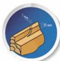
Système «GUILLAUME» breveté (modèles GR120P et CE120P). Permet une reprise de feuillure latérale illimitée mm par mm jusqu'à une hauteur de coupe de 25 mm.
