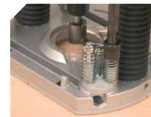
Sélection de la profondeur de travail par butée revolver à 3 positions.
