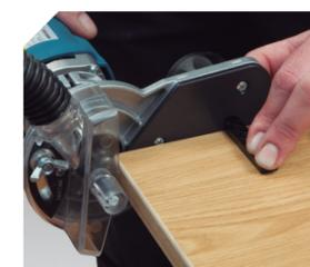
Dispositif de guidage pour l'affilage logé dans l'extrémité du chant
