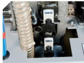
Réglage précis du profil des fraises et des palpeurs à l'aide d'un compteur sico.
