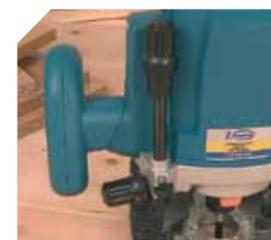
Réglage micrométrique de la profondeur de défonçage et butée revolver à 6 positions.
