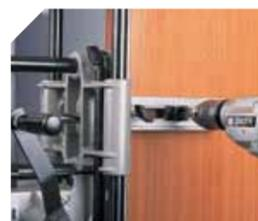
Dispositif UT16I pour le repérage et perçage de l'emplacement du cylindre et de la béquille.
