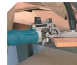
Affleurement avec la fraise droite standard incluse dans l'équipement d'origine.
