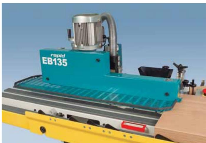
Pour assurer un bon placage du chant, l'EB135 est équipée d'un entraîneur qui permet un placage assisté et sans effort. Elle dispose également de rouleaux auxiliaires sur la table et une règle équipée avec des presseurs, lesquels assurent une pression optimale sur l'unité de collage. Ainsi, l'adhérence du chant est assurée, en particulier lorsque des bords épais et matériau rigide sont utilisés.
