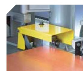
Coupe avant et arrière rigoureusement précise pour les chants jusqu'à 2 mm d'épaisseur.
