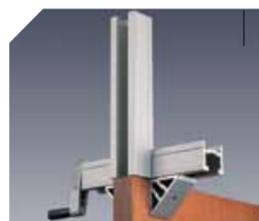
Le dispositif UP16I permet de fixer la machine en dépassement de l'angle de la porte pour une mortaise plus haute.
