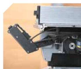
Poignée réglable en hauteur, servant également au transport de la machine.
