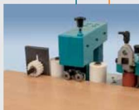
Unité d'arasage motorisé AK97NW, rouleaux plaqueurs et rouleau presseur vertical en sortie de panneau. Arase des chants jusqu'à 1 mm d'épaisseur.
