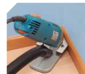
Surfaçage d'un angle de pièce.
