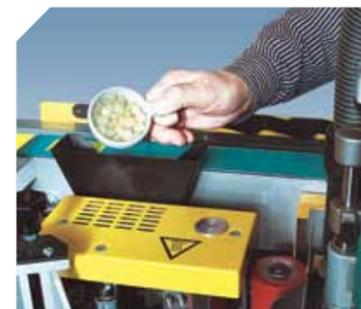
Trémie pour faciliter le remplissage du bac à colle. Comprend un distributeur pour le remplissage de la colle pendant le processus de travail sans arrêter la machine.
