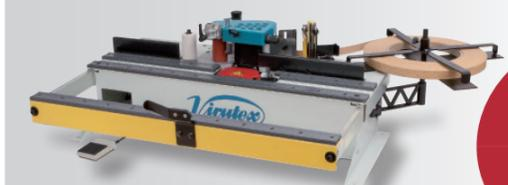
Semblable au modèle PEB250TRM. Il comprend coupe arrière automatique. Ne comprend pas le profileur motorisé (en option), les guides de rallonge de table (en option) et les supports presseur (en option).
