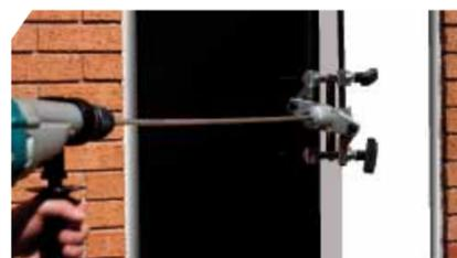
**Charriot guidage pour porte à recouvrement (Réf. 443971 RECOU.)**
