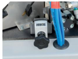
Réglage simultané de l'ouverture du guide chant, de l'alignement des règles d'entrée et de l'alignement du rouleau applicateur de colle par un seul compteur sico.
