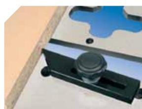
Butée réglable pour une position parfaite et possibilité de rattraper les faux équerrages (entre mur et plan de travail).
