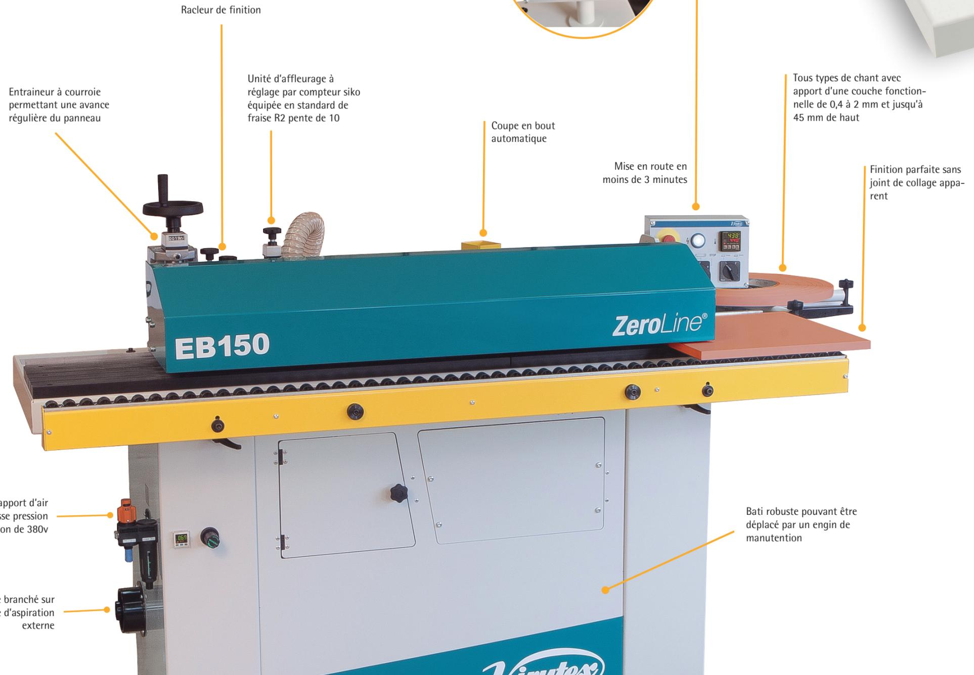
Entraîneur à courroie permettant une avance régulière du panneau
