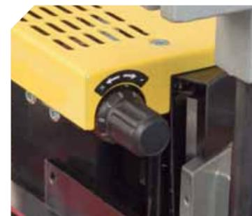
Dispose également d'un bouton pour le réglage de la quantité de colle, permettant de travailler avec efficacité avec les chants de différents matériaux.
