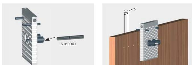
Rangées de trous de 5 mm dans une trame de 32 mm en décalant la plaque
