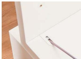
Assembler les éléments avec une visseuse sans fil et l'outil Cabineo. Travail simple et rapide avec un couple pré-réglé d'environ 2,5 Nm
