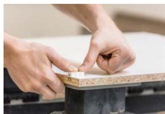
2. Montage de l'élément d'assemblage monobloc
