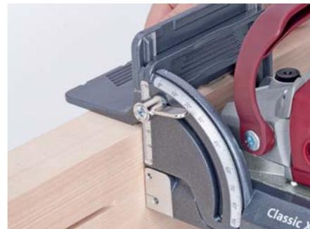
**Réglage variable de la position de rainure** par rapport à la surface de butée 0 – 50 mm
