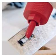
L'ajout de colle dans l'élément d'assemblage augmente la résistance à la rupture de 30 %
