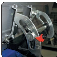
Guide en profilé aluminium inclinable à 45°
