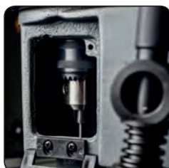
Système de mandrin pour fixation de la mèche
