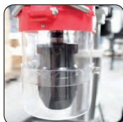
Carter de mandrin basculant et réglable
